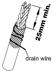
Entfernen Sie vom Kabelende mindestens 25 mm des Kabelmantels. Ziehen Sie den Gesamtschirm über den Kabelmantel undwickeln den Beidraht wie dargestellt um den Schirm. Paarschirmungen radial schneiden und entfernen. Den Paarschirm nur soweit kürzen, dass er möglichst tief in die Aderaufnahme hineinreicht.
