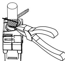
Schneiden Sie den Kabelbinder ab. Beidraht und Schirm dürfen dabei nicht abgeschnitten oder beschädigt werden.
