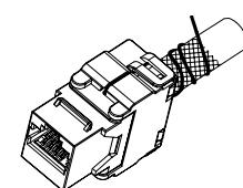
Stellen Sie sicher, dass der Beidraht um das Kabel und den Schirm gewickelt ist.
