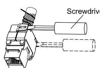
Um das Gehäuse zu öffnen, drücken Sie einen kleinen Schraubenzieher in die Kerbe der Verriegelung.
