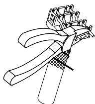
Schneiden Sie die überstehende Ader so nahe wie möglich an der Außenkante der Aderaufnahme ab.
