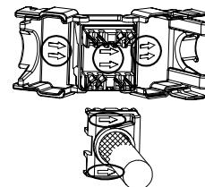
Stellen Sie sicher, dass die Pfeile auf der Aderaufnahme und dem Gehäuse in dieselbe Richtung zeigen.
